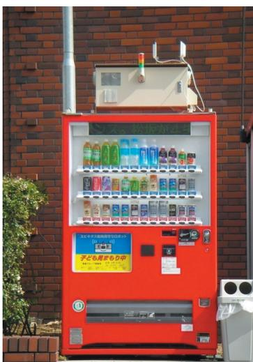
大阪市立中央小学校の校区内に設置されたICタグの読取り機。ICタグをつけたランドセルを背負った子供が近づくと電波を読み取る仕組み。自販機を改造してアンテナ、センサー、警告灯、スピーカーが取り付けられている
